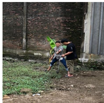
Gambar 2. Kegiatan pengeboran dengan pipa ulir
